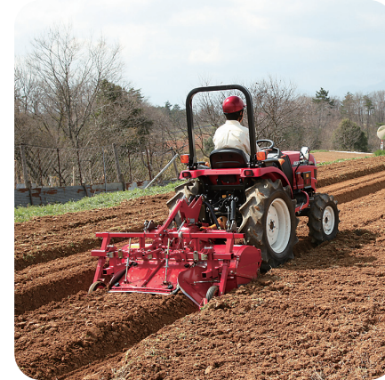
畦立て作業（ナブラ平高うねロータリー整形機）
