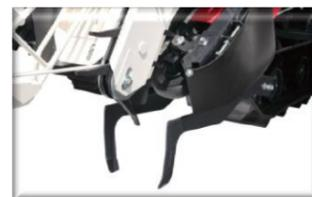
2 連続の側面 L 形サブソイラが人参を土から浮かせて、硬いほ場でも無理な力をかけずに引き抜き、また、土壌抵抗が少ない形状により、速度アップにも貢献します
