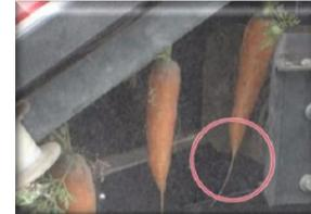
人参の大・小や掘取り高さが違ってても、人参をスムーズにカット。また、シリンダカッターを採用することで、搬送スピードが上がっても確実に根を切断。きれいな仕上がりを実現します。
