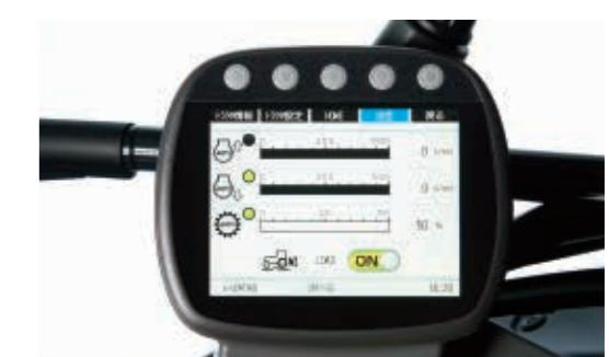
作業状況に合わせて、エンジン回転と車速を自動制御。
