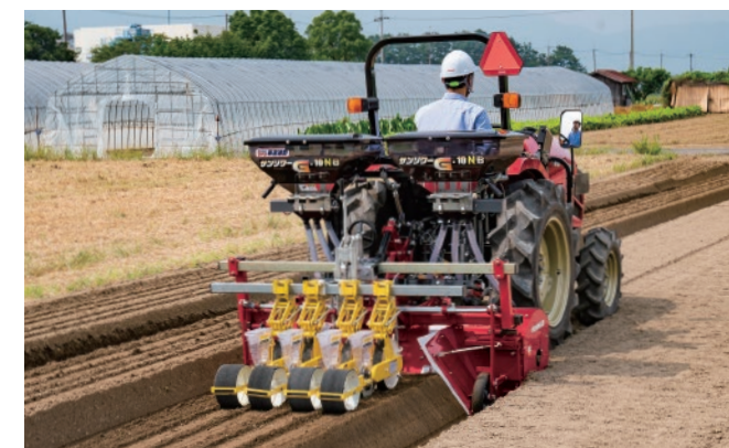
うね立て同時播種・施肥作業 平高整形ロータリ 〈ヤンマーアグリ(株)〉 施肥機 〈(株)ジョーニシ〉 播種機 〈アグリテクノ/矢崎(株)〉
