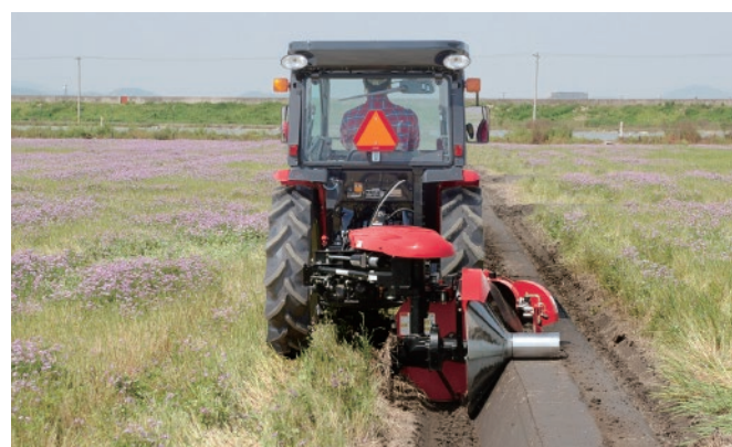
あぜ塗り作業 あぜ塗り機 〈小橋工業(株)〉
