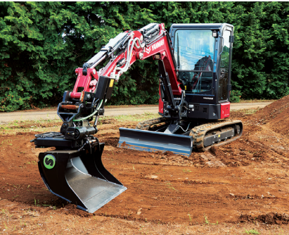
敷き均し 最小限の走行で敷き均し作業が可能に。
