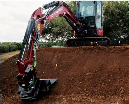
整形作業 回転＋チルトを活用し最小限の走行で法面作業が可能に。
