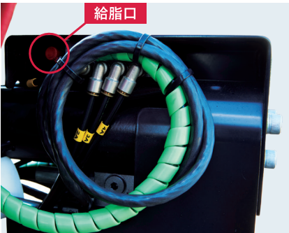
集中給脂 グリス給脂を1箇所から複数の給脂箇所へ行き渡らせることができるシステムです。
