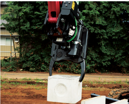
グリッパー 物の移動・設置が容易、かつ安全に出来るようになります。
