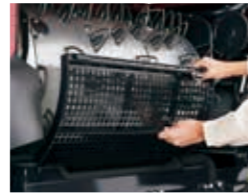
高張力鋼板受け網脱着
