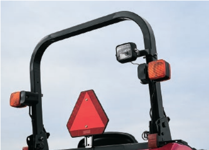
ワークランプ(安全フレーム) 安全フレームに取り付けるワークランプキットです。
