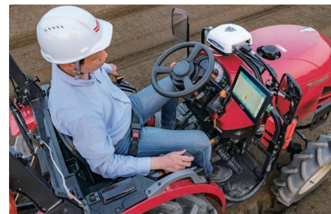
自動操舵システム 〈(株)ニコントリンプル〉 平高整形ロータリ 〈ヤンマーアグリ(株)〉
