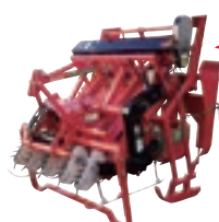
ニンニクハーベスタ HN405D 45～70PSトラクター用 適応条数:4条 P197 (ササキコーポレーション)
