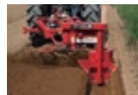
溝掘機 周囲に明きよを掘ることで、表面水をすばやくほ場外へ排出。
