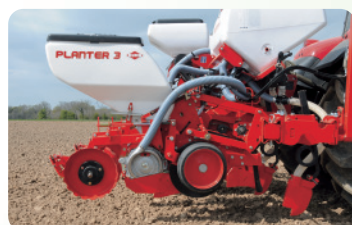
オープニングディスク式播種ユニット(O仕様) ※本カタログに掲載の写真はヨーロッパ仕様につき、日本仕様とは異なります。
