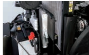
新型コア採用ラジエータ 様々な条件下でもオーバーヒートを防ぎます。
