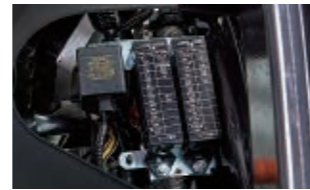
ヒューズボックス ヒューズの点検・交換が簡単にできます。
