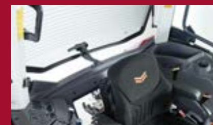
■ リヤウィンドウ 換気のため半開き固定ができます。また、リヤアンダーガラスも採用しました。
