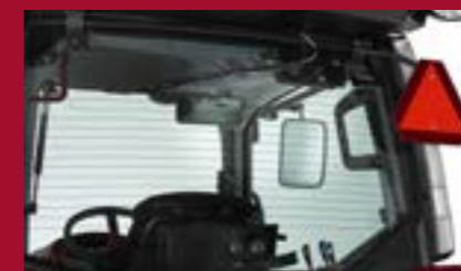
■ リヤデフォッガ (YT5114Rのみ) リヤウィンドウの曇りや霜、水滴を除去できます。
