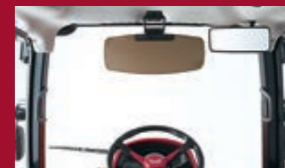
■ サンバイザ&ルームミラー 直射日光下でも視界を守ります。
