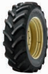
ラジアルタイヤ ラジアルタイヤはけん引力の増大、土壌への踏圧の緩和、燃費向上、乗り心地の向上、耐久性に優れています。
