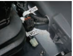
外部電源40A+20A シート右後ろに2つのコネクタを装備。大容量化する作業機の電源取り出しに対応します。
