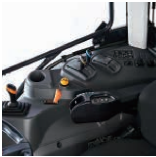
マニュアルシフト仕様 使いやすようにシートの右側にスイッチ・レバー類を集中して配置しました。
