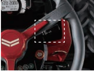
オートキャンセルウィンカ ハンドルを戻すとウィンカが自動的にキャンセルされます。
