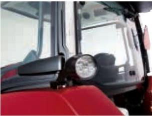
LEDリヤワークランプ (フェンダー) 夜間作業時など後方の視認性を 高めます。
