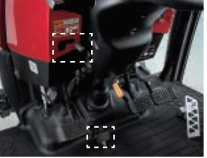
片ブレーキあんしん機構 移動走行時の左右ブレーキペダル連結忘れを防止します。
