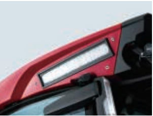
エアコン外気フィルタ 外気フィルタをキャビンルーフ左側面に設置しました。(キャビン仕様)
