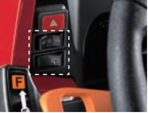
ワイパースイッチ フロントワイパーは間欠作動できます。(キャビン仕様)
