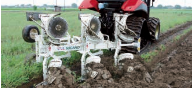
反転耕作業：リバーシブルプラウ（スガノ農機）
