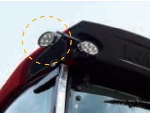
LEDリヤワークランプ (ルーフ) 夜間作業時など横・後方の視認 性を高めます。
