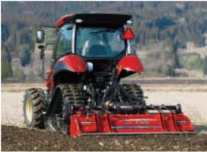
③高い作業精度 接地面積が多く、凹凸による機体の上下動が少なく、様々な作業が安定した姿勢で行えます。
