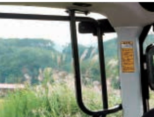
インプルモニターステー 作業機の操作BOX等を取付でき ます。
