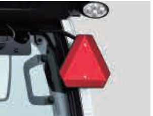
低速車マーク 夕暮れや夜間の追突事故を回避するために低速車マークを標準装備しています。
