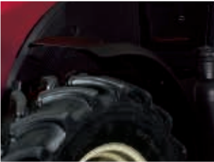
フロントフェンダー 移動走行時の泥はねを防ぎます。
