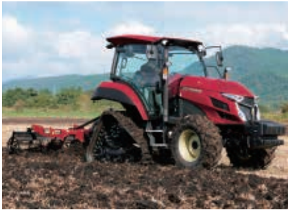
①低接地圧 土を踏み固めないで作物の育成によく、雨上がりのぬかるんだほ場でもすぐに作業ができます。
