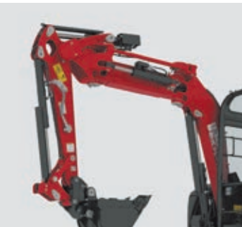
AUX1 足踏み操作のアームエンド配管です。
