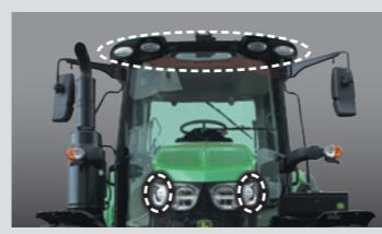
作業灯 LED作業灯(フロント6灯、側方2灯、リヤ4灯)により夕暮れ時や夜間作業でも明るく周囲を照らします。
