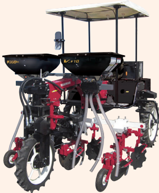
※写真は中耕ディスクに施肥機を装着。
