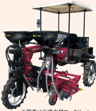
※写真は三連中耕ロータリー＋イエロー培土器×3個に施肥機を装着。
