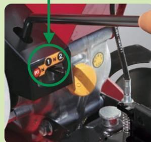
硬いほ場での耕うん作業やアタッチメントでの深耕作業など、条件や作業に応じた速度が選べます。また、バック速があるので狭いほ場でもスミズミまで小回りを利かせて耕うんできます。
