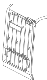
4柱キャノピー仕様(ROPS※1/FOPS※2基準)
