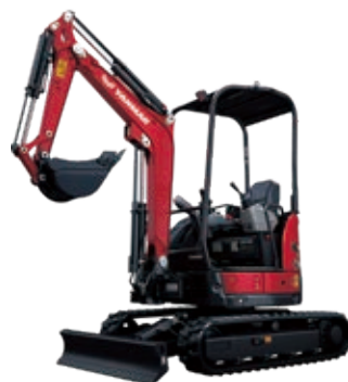
4柱キャノピー仕様(ROPS※1/FOPS※2基準)
