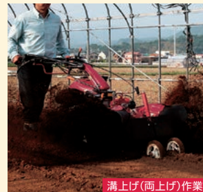
溝上げ(両上げ)作業
