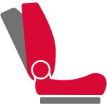
4 リクライニング+スライドシート オペレーターの身体の大きさや姿勢 に合わせて調整可能です。
