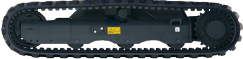
強固な足回り 独自の厳しい耐久基準をクリアし、履帯外れや磨耗を防ぎます。
