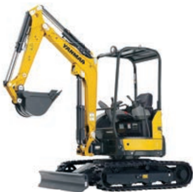
4柱キャノピー仕様 (ROPS※1/FOPS※2基準)
