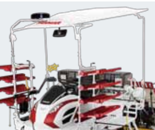
■ 大型サンバイザー 〔オプション〕 作業中に運転者を日差しから守るほか、施肥機のホッパーまで覆うので雨でも肥料補給が快適に行えます。
