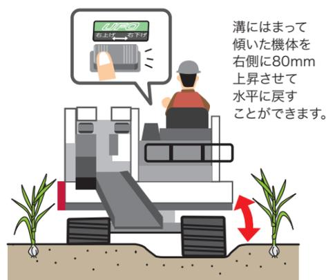
溝にはまって傾いた機体を右側に80mm上昇させて水平に戻すことができます。
