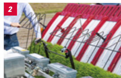
2 苗マット押さえオープン 上下から解除できるので、苗を取り出しやすい。
