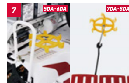
7 風車マーカ収納 ワンタッチで収納でき、取り外しも簡単。
