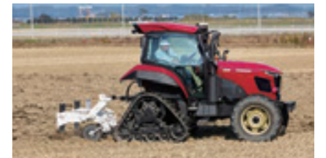
■ 心土破碎作業: サブソイラ
