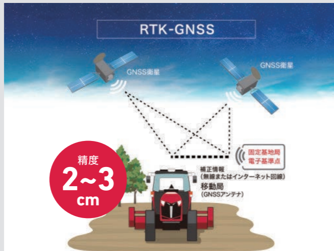
GNSS(GPS, GLONASS等) 衛星と固定基地局や電子基準点からの補正情報で位置を求める測位方式 RRS方式・VRS方式ともに対応しています。
