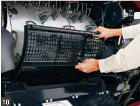
10 高張力鋼板受け網脱着
