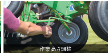
作業高さ調整
