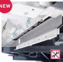
② グレンタンク下部 底のフタをノンツール化。
