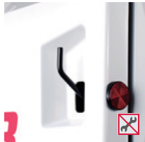
⑫ 脱こくオープンレバー 脱こく部がレバー1本で開き、掃除が簡単にできます。
