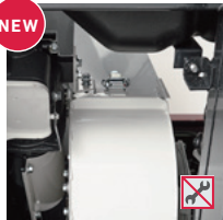
⑪ 昇降機下部 底のフタをノンツール化。
