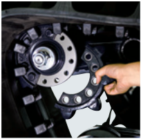
⑬ クローラ駆動分割スプロケット クローラを外さずにスプロケットの交換が早くなります。
