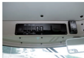
ヒータースイッチ組み込みの オーバーヘッドコンソール
