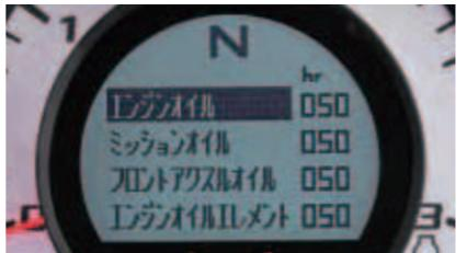
液晶メーターでオイル・エレメントの交換時間を表示可能
