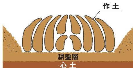
ディスク1枚ごとに下層までタテの空気の層ができ、通気性・透水性を高め、根が伸びやすい団粒構造をつくります。また、堆肥・ワラなどをきれいにすき込むと同時に、微生物や空気を下層部に埋め込んで有機物の分解を促進。地力を高め、作物の生育に適した理想的な圃場がつくれます。
