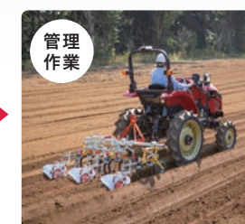
移植作業をしたPW200Rの方位角をトラクターに入力して中耕・除草・培土作業に利用
