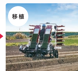
トラクターで耕うんまたはうね立てをした方位角をPW200Rに入力して移植作業にも利用
