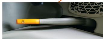
비상 브레이크 풋 브레이크 고장 시 트랙터를 안전하게 정지시킬 수 있음
