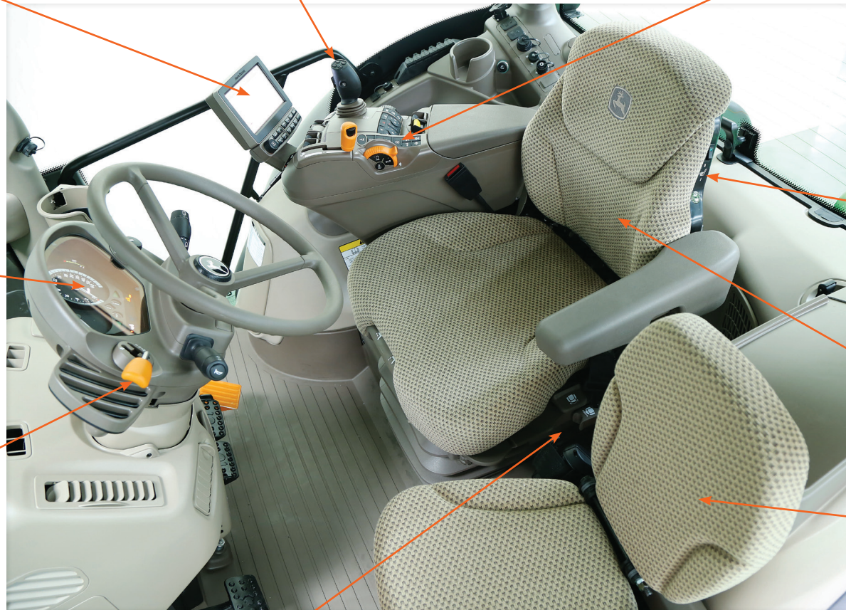
비상 브레이크 풋 브레이크 고장 시 트랙터를 안전하게 정지시킬 수 있음
