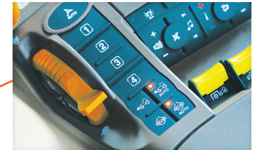
전륜구동, 차동고정 자동기능 채용 주행속도와 조향각을 인식해 자동으로 연결/해제 기능
