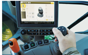
스마트형 조이스틱 조이스틱 레버로 전후방 SCV 조작 및 전후방 히치 제어 가능
