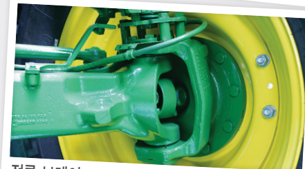
전문 브레이크 기본장착(오토파워 50km/h 사양)
