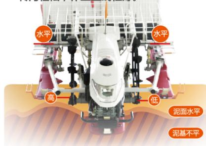
独特的液压结构，机器作业时浮船可感应田块高低变化，控制底盘离地间隙。
