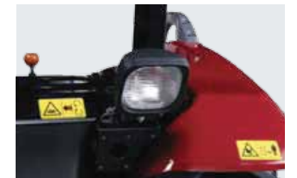
ไฟหมอก (1A8253-54100) เพิ่มแสงสว่างด้านหลังแทรกเตอร์ ในการทำงานเวลากลางคืน ได้อย่างเพียงพอ
