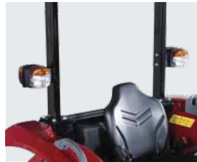
โครงสร้างนิรภัย ROPS มาตรฐานความปลอดภัยจากยี่ห้อผู้ผลิต ช่วยป้องกันผู้ขับขี่ กรณีเกิดอุบัติเหตุ
