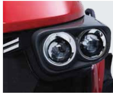
ไฟหน้าแบบโปรเจกเตอร์ สว่าง ชัด ทั้งแบบไฟสูงหรือไฟต่ำ ทำงานได้ดี แม้ในเวลากลางคืน หรือเวลาเดินทางกลางคืน
