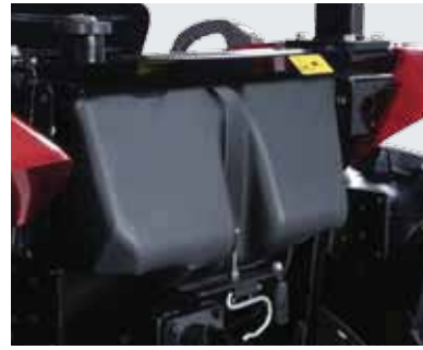
ถังน้ำมันความจุสูง ถังน้ำมันขนาด 50 ลิตร ทำงานต่อเนื่องได้ทั้งวัน โดยไม่ต้องหยุดเติมน้ำมันบ่อยๆ
