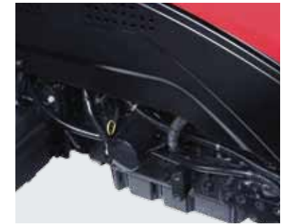
จุดถ่ายน้ำมันเครื่อง/กรองน้ำมันเครื่อง วางอยู่ในตำแหน่งที่เข้าถึงง่ายต่อการบำรุงรักษา และตรวจสอบระดับน้ำมันเครื่อง โดยไม่ต้องถอดชิ้นส่วนอื่นๆ ออกให้ยุ่งยาก
