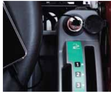
ช่องเสียบไฟขนาด 12 โวลต์ เสียบชาร์จโทรศัพท์มือถือหรืออุปกรณ์อิเล็กทรอนิกส์ต่างๆ ได้ในขณะที่ทำงาน จ่ายไฟสม่ำเสมอ ไม่กระชาก
