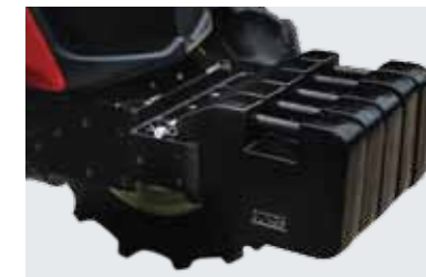
เหล็กถ่วงหน้า (1A8253-10300) แขนใส่เหล็กถ่วงหน้า (1A8253-10200) ติดตั้งเหล็กถ่วงหน้าได้ถึง 5 ลูก หรือ 30 กิโลกรัม เพื่อเพิ่มเสถียรภาพในการทำงาน
