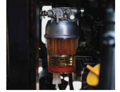
กรองแยกน้ำมัน/น้ำ ขนาดใหญ่ ป้องกันน้ำ ความชื้น ผุ่น เข้าไปในเครื่องยนต์ ตรวจสอบเช็คได้ง่ายขึ้น
