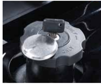
ตัวล๊อคฝาถังน้ำมัน ป้องกันการขโมยน้ำมันภายในถัง
