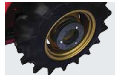
เหล็กถ่วงล้อหลัง (1A8253-34990) ติดตั้งเหล็กถ่วงล้อหลัง 1 ลูก (20 กิโลกรัม) และ 2 ลูก (25 กิโลกรัม) หรือมากที่สุด 70 กิโลกรัม เพื่อเพิ่มแรงดุดลากในการทำงาน
