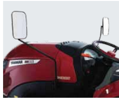
กระจกมองข้าง มาตรฐานทั้งด้านซ้ายและด้านขวา ลดมุมอับ เพิ่มมุมมองให้การทำงานสะดวกยิ่งขึ้น
