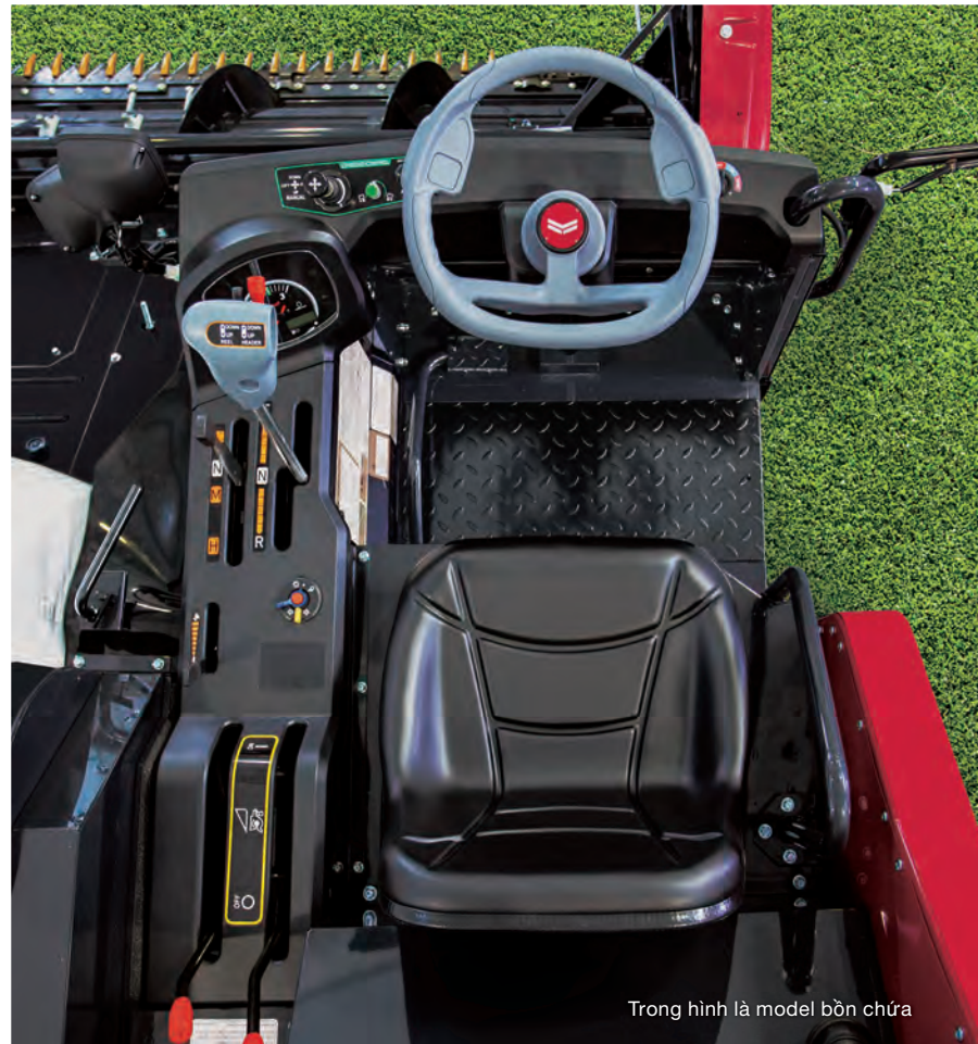
Nút điều khiển độ cao hàm cắt
