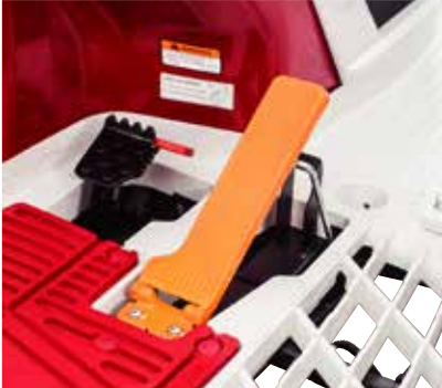
Bàn đạp điều khiển tốc độ (bàn đạp ga chân) Di chuyển, dừng lại, tăng tốc và giảm tốc độ được thực hiện chỉ với một bàn đạp ga chân duy nhất. Người vận hành có thể tập trung cho việc lái máy bằng cả hai tay. Điều này giúp người vận hành thoải mái và ít mệt mỏi hơn rất nhiều.
