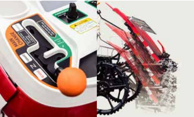
Cần số chính và hệ thống hỗ trợ Khi cần số chính ở vị trí lùi, dàn cấy phía sau sẽ tự động nâng. Qua đó giúp máy lùi về sau nhẹ nhàng.
