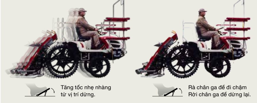
Bàn đạp điều khiển tốc độ (bàn đạp ga chân) Di chuyển, dừng lại, tăng tốc và giảm tốc độ được thực hiện chỉ với một bàn đạp ga chân duy nhất. Người vận hành có thể tập trung cho việc lái máy bằng cả hai tay. Điều này giúp người vận hành thoải mái và ít mệt mỏi hơn rất nhiều.
