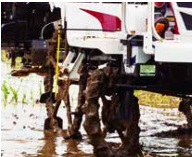
Chuyển hướng không cần hãm phanh Chuyển hướng nhẹ nhàng và không cần phanh, làm cho bề mặt ruộng ít bị cây phá, đặc biệt là đầu bờ ruộng.
