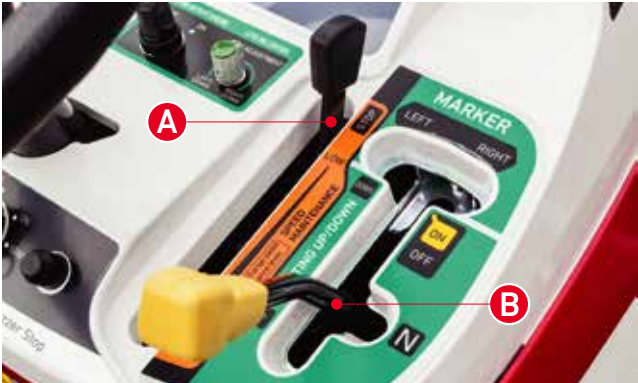
Cần ga tay (A) - Cố định chân ga Gài cần này ở vị trí mong muốn, tốc độ cấy sẽ giữ nguyên không đổi, kích hoạt chế độ tự động chạy ngay cả khi bỏ chân khỏi bàn đạp ga Cần nâng hạ bộ phận cấy (B) Chiều cao của bộ phận cấy và điều khiển thanh kẻ vạch có thể được điều khiển dễ dàng chỉ bằng 1 cần duy nhất.
