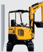
Escavação lateral de valas bem próxima à parede sem sair do alinhamento.
