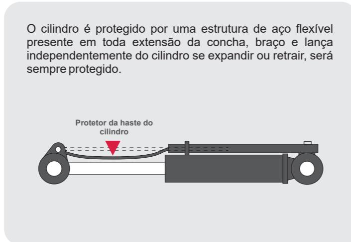
O cilindro é protegido por uma estrutura de aço flexível presente em toda extensão da concha, braço e lança independentemente do cilindro se expandir ou retrair, será sempre protegido.
