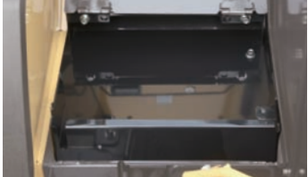
工具箱标准配置，除日常点检用工具以外，还可以放置备用斗齿。
