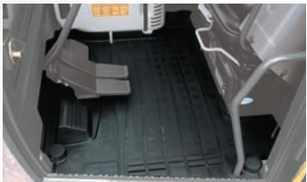
端部突起的驾驶室地板胶垫，防尘、清扫容易。
