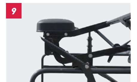
アンテナユニット 収納時には前方に回転することができます。
