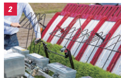
苗マット押さえオープン 上下から解除できるので、苗を取り出しやすい。
