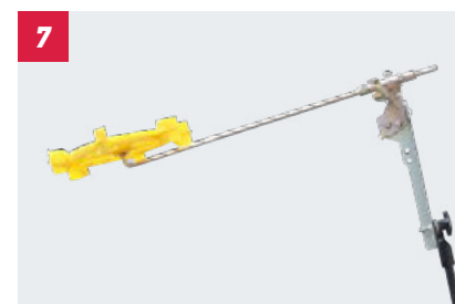
風車マーカ 土を盛り上げて跡をつくるので直進の目安がよく見えます。
