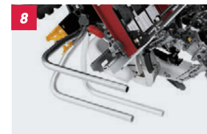
スタンド兼用ガード 作業時は機械を守り、折りたたむとスタンドに。
