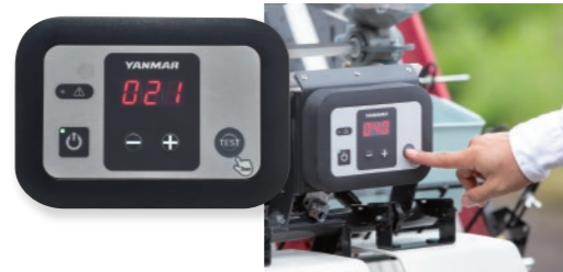
カラーディスプレイ画面からもアタッチメントのON/OFF、散布量の調節が可能
