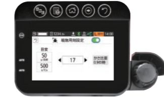
カラーディスプレイ画面からもアタッチメントのON/OFF、散布量の調節が可能
