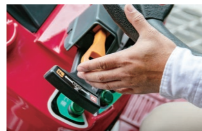
Rターン旋回時の前後進切り替えはリバーサー操作でスムーズにおこなえます。
