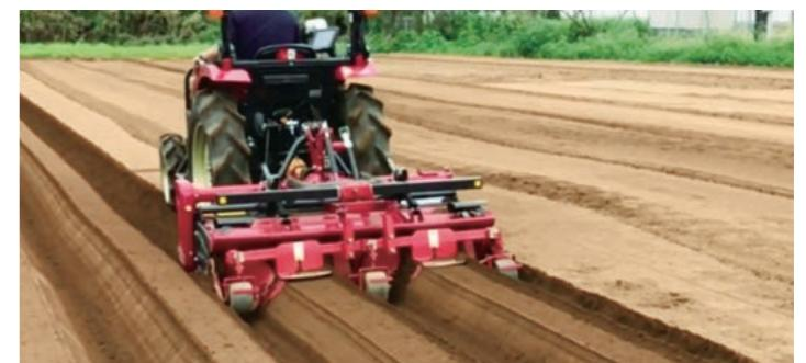
精度±2~3cmの作業に適した高機能モデル。自動操舵は、超低速から高速まで安定。
