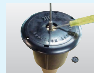
蓋カバー取り外し状況
