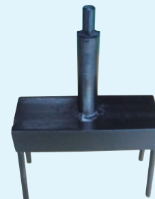
インターナル上部、下部 分解用タワー
