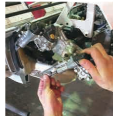
プッシュロッドの点検
