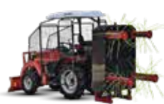
โครงกันอ้อย พร้อมเครื่องสางใบอ้อย
