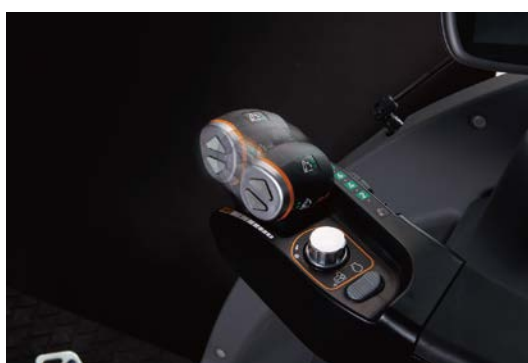
< 無段変速トランスミッション I-HMT を操作する変速レバーイメージ >
