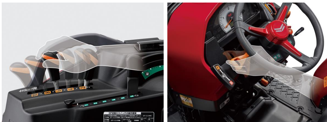
< 「主変速レバー」(写真左) と 「フィンガータッチリバーサ」(写真右) >
