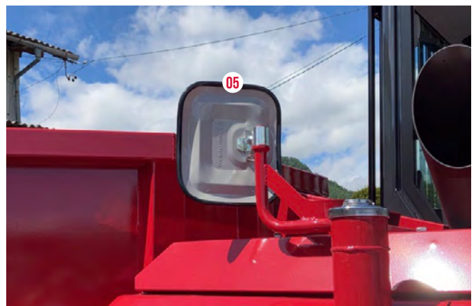
04 05 Nuovo specchietto per la posizione di retromarcia del sedile per migliorare la visibilità laterale posteriore a sinistra
